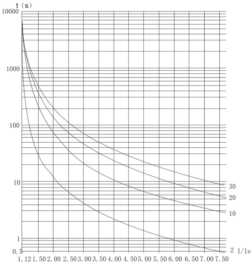
电机热保护脱扣时间曲线（热状态）
